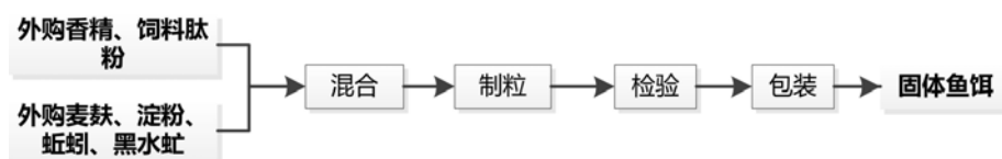
图 2-6 固体鱼饵生产工艺流程图
