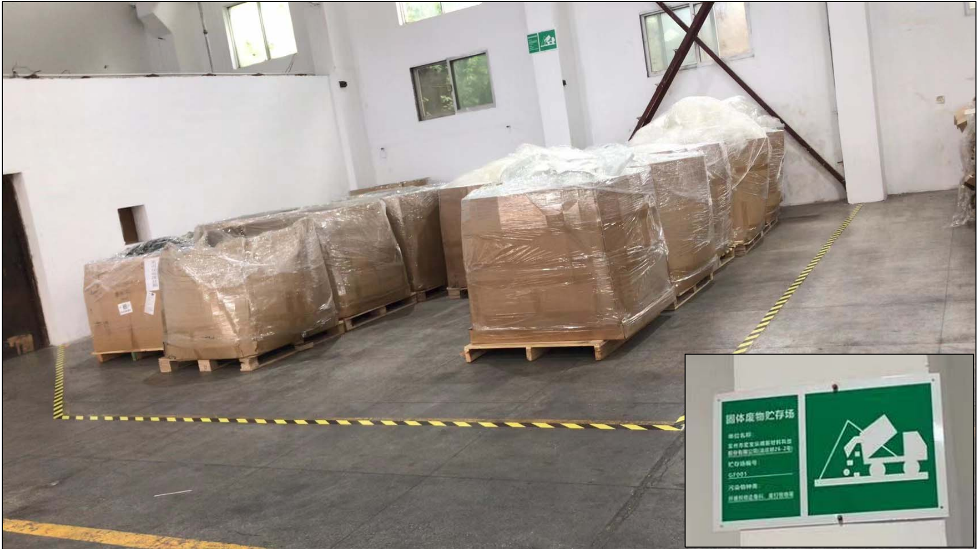
车间内一般工业固废堆场，已设置环保标识牌，堆场面积30m 2
