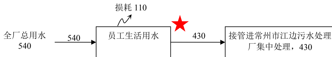
图 2-1 全厂水平衡图 单位：吨/年
